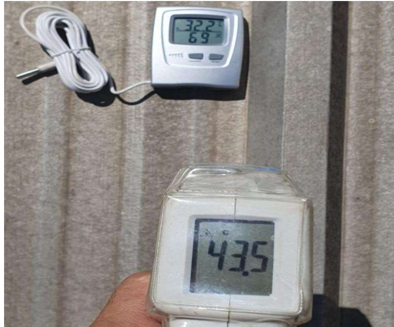
Figura 13 – Medição de temperaturas da cobertura com telhas isotérmicas.
